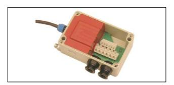
Регулятор состоит из электронной части с микропроцессором, которая полностью залита силиконом, и отделением для клемм с EEx е клеммами. Регулятор оснащён тримя аналоговыми входами:
