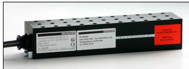
CP BLOCKTHERM это металлический блок, в который встроены нагревательный патрон и температурный сенсор для электронного ограничения температуры поверхности.
