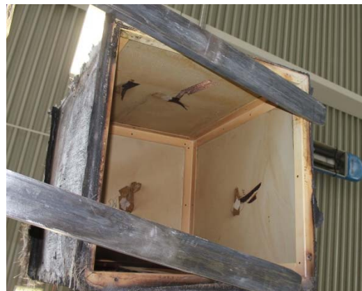
Fire Shelter Innenansicht nach >60min. bei 1200°C /2000°F
