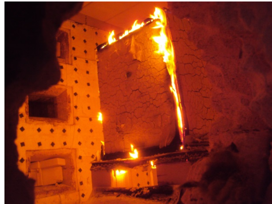
Fire Shelter in Flammenkammer bei 1200°C/ 2000°F
