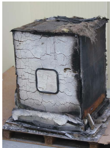
Fire Shelter nach Versuch >60 min. bei 1200°C /2000°F
